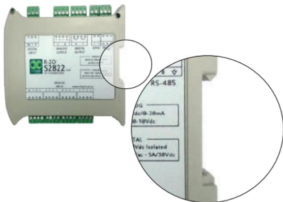
Figura 2. Instalação em trilho DIN.
